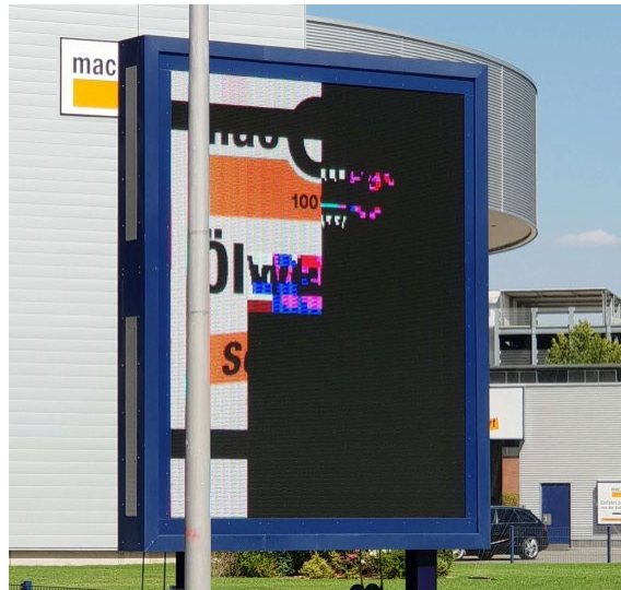
falsch dimensioniertes LED Display bei Außentemperatur von 38°C
